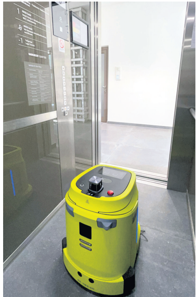
Der Roboter reinigt auf dem Weg zum nächsten Stockwerk auch die Aufzugskabinen. Quelle: Schindler Deutschland
